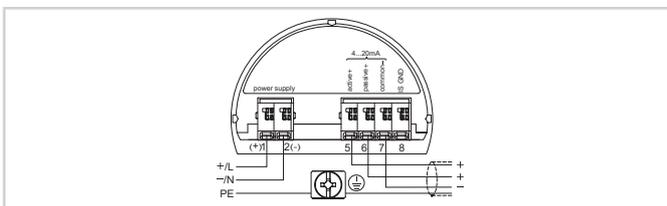
Отсек подключения (двухкамерный корпус)
